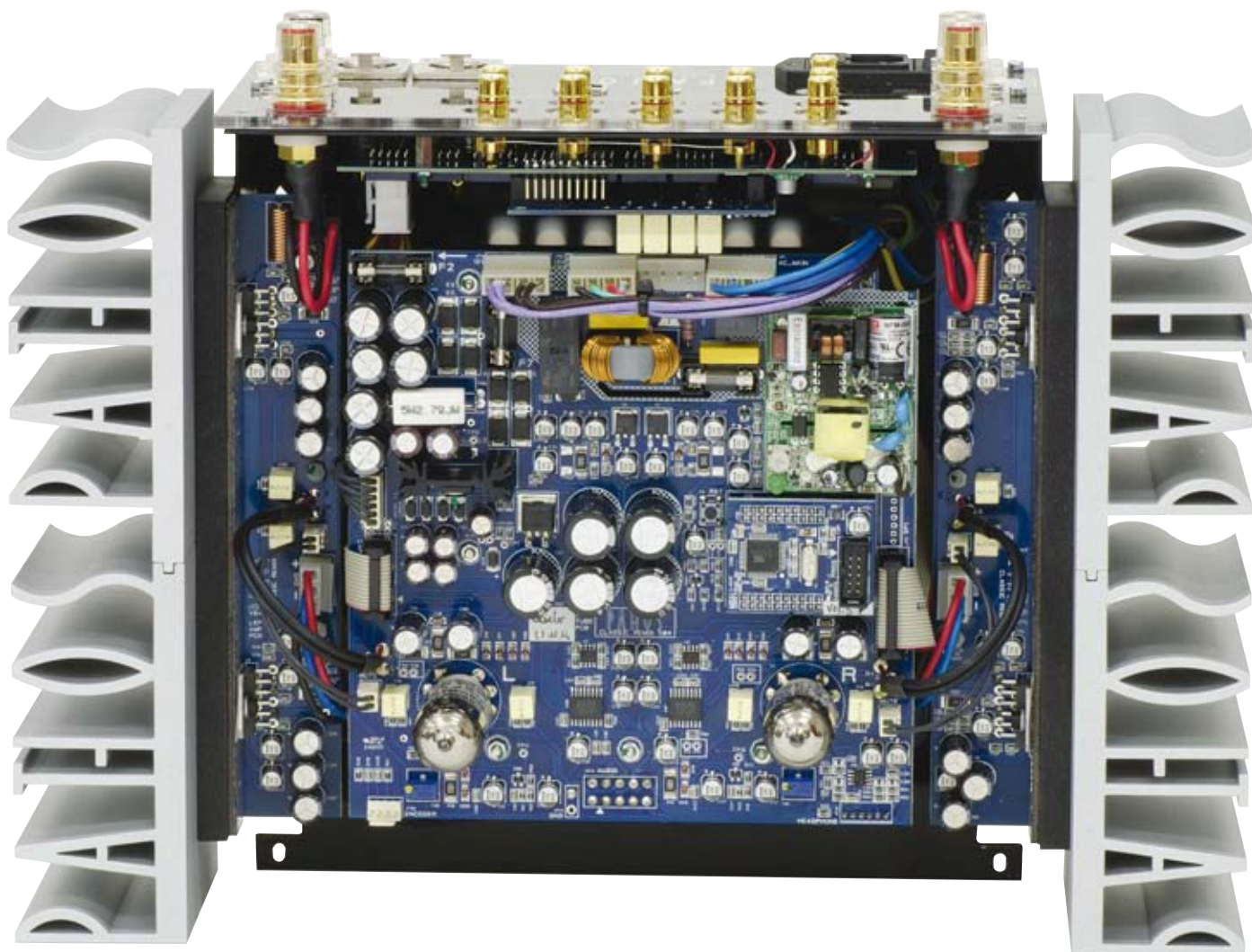
Il colpo d'occhio interno rende onore allo studio di ingegnerizzazione svolto per concentrare tutti i circuiti in un cabinet compatto. Le varie sezioni sono collocate su diversi livelli e su più schede, talune anche in posizione verticale, a riempire tutti gli spazi.
