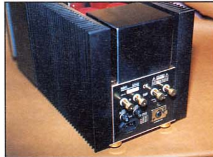
Sul pannello posteriore di ogni Inpower sono presenti due coppie di morsetti di uscita per il biwiring e il solo ingresso bilanciato.
